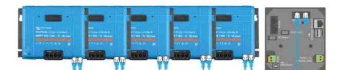
Mit VE.Can können bis zu 25 Laderegler in Reihe geschaltet und an ein GX-Gerät wie Color Control GX angeschlossen werden. Jeder Regler kann einzeln überwacht werden, z.B. auf einem Color Control GX oder der VRM-Website
